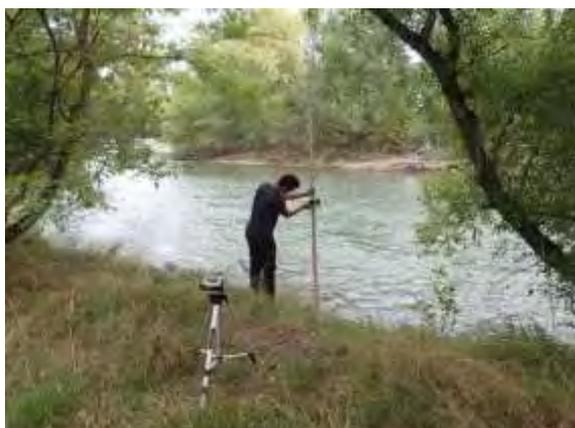
Calcul de la hauteur de berge à l'aide d'un laser et d'une mire
